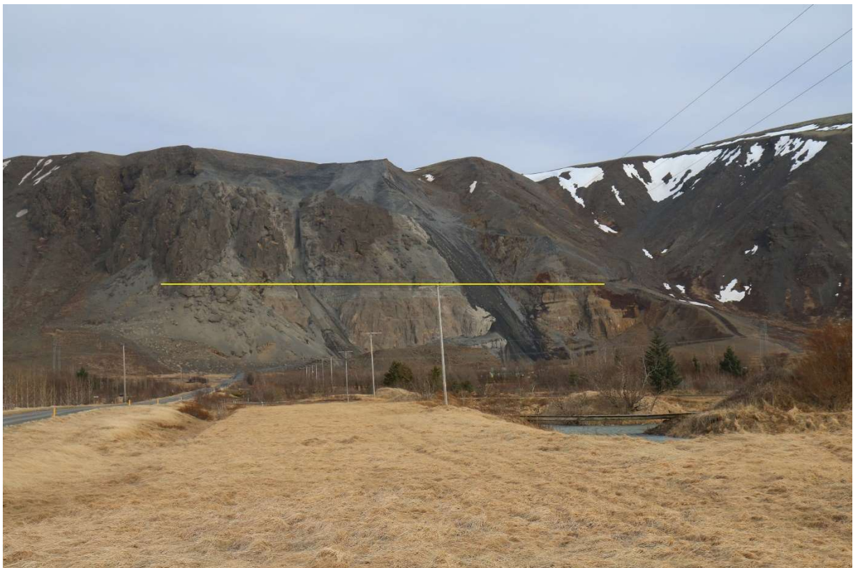
MYND 3.1 Valkostur B. Efnistöku yrði haldið áfram þar til komið er að þéttum berggrunni í neðri hluta Ingólfsfjalls, nokkurn veginn við gulu línuna á myndinni.
